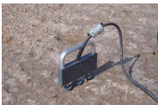
شکل ۸- اندازه گیری رطوبت خاک
