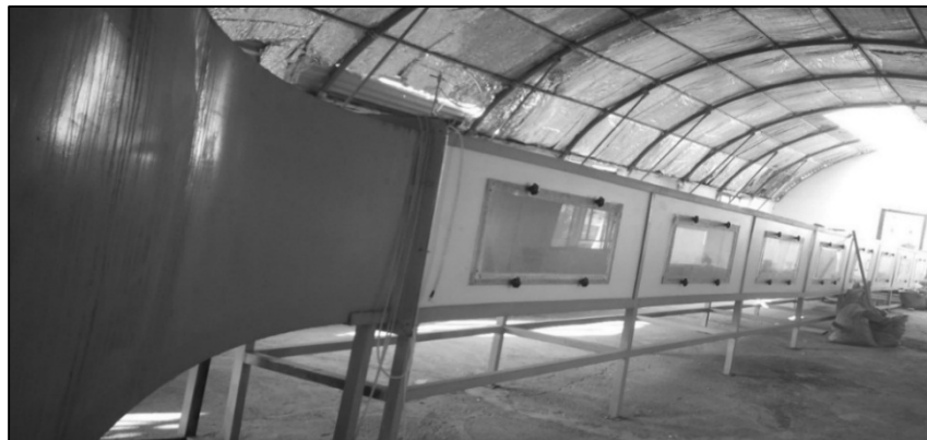
شکل ۲- تونل باد مورد استفاده برای انجام فرایند فرسایش بادی به ترتیب از چپ به راست (فن، یکنواخت‌کننده توزیع هوا، مبدل و محفظه آزمایش)
