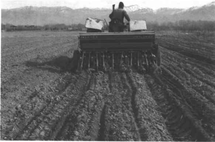
شکل شماره (۴): بذرکار در حال انجام کاشت سطحی
