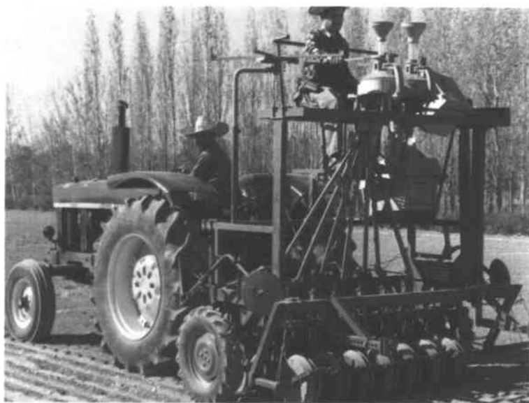
شکل شماره (۲): ماشین بذرکار تحقیقاتی در حال کاشت
