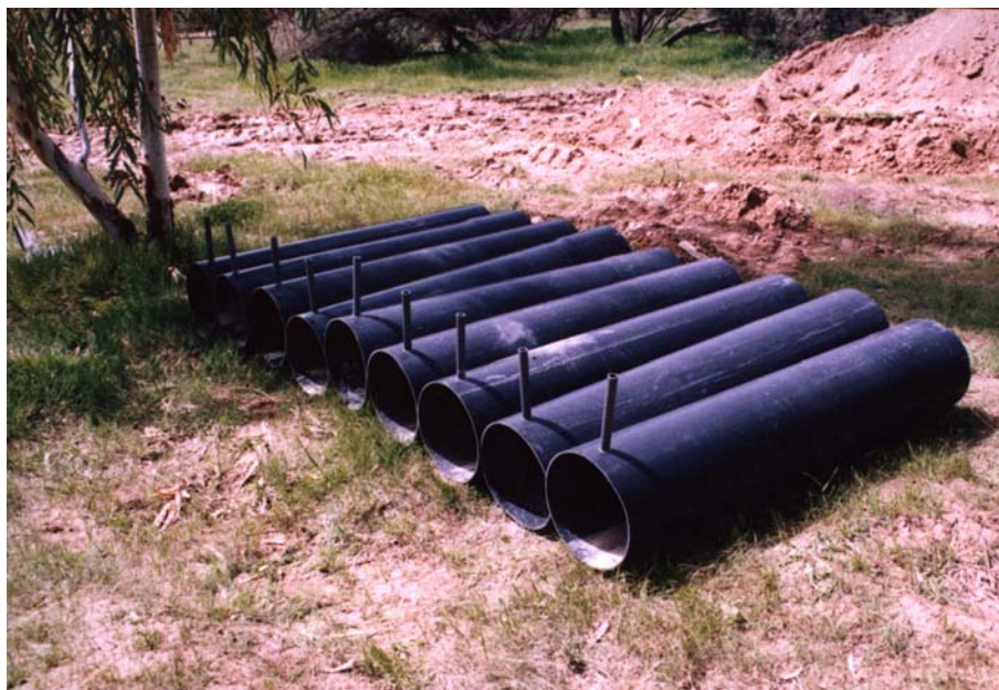
شکل ۱- آماده سازی لوله‌های پلی اتیلن برای آزمایش آبشویی در شرایط مزرعه
