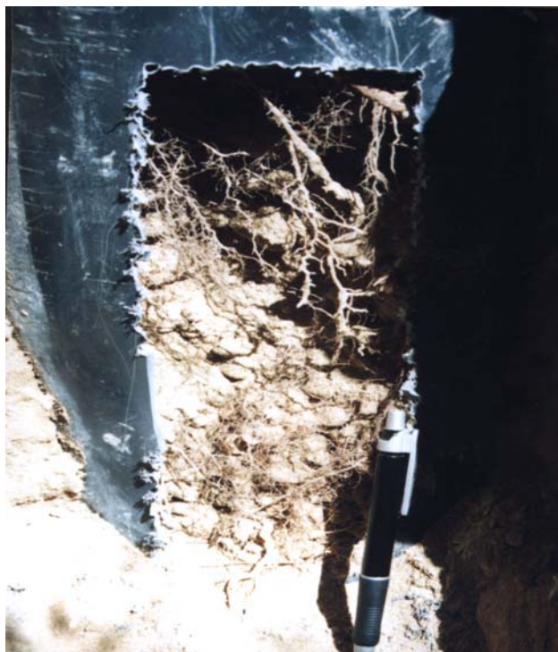
شکل ۳- توسعه‌ی کامل ریشه‌های اکالیپتوس پس از آزمایش آبشویی در مزرعه با باز کردن انتهای لوله‌های حاوی نهال مورد بازبینی قرار گرفت.
