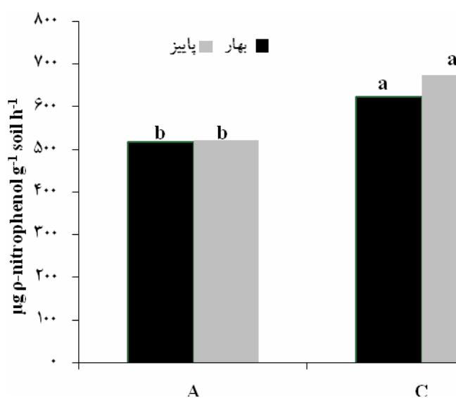
شکل ۲- تغییرات آلکالین فسفاتاز بر حسب میکروگرم نیتروفنل در گرم خاک در مناطق نمونه‌برداری شده در بهار و پاییز ۱۳۸۸. A: منطقه آتش‌سوزی شده، C: منطقه شاهد. هر ستون نماینده میانگین ده داده‌ی آنزیمی است. گروه‌های مشابه با حروف انگلیسی یکسان مشخص شده‌اند. تفاوت‌ها در سطح اطمینان ۹۵ درصد ارائه شده‌اند.
