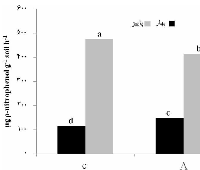
شکل ۴- تغییرات اسید فسفاتاز بر حسب میکروگرم نیتروفل در گرم خاک در مناطق نمونه برداری شده در بهار و پاییز ۱۳۸۹. C: منطقه شاهد، A: منطقه آتش سوزی شده. هر ستون نماینده میانگین ده داده‌ی آنزیمی است. گروه‌های مشابه با حروف انگلیسی یکسان مشخص شده‌اند. تفاوت‌ها در سطح اطمینان ۹۵ درصد ارائه شده‌اند.
